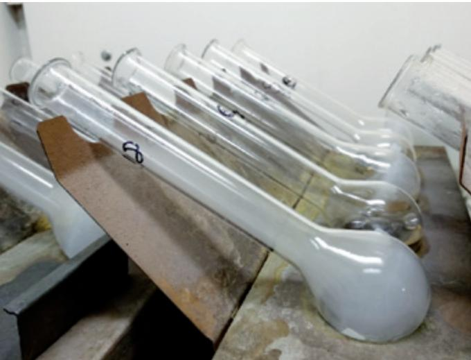
*Digestion of samples for organic nitrogen determination. / Mineralizace vzorků pro stanovení organického dusíku. (Foto: P. Porcal)*
